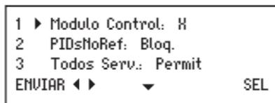
Módulo de Control : Debe indicarse si el presente módulo transmódulador ejerce o no funciones de control dentro del conjunto de transmóduladores que componen la cabecera (el transmódulador de control es el posicionado como el último a la derecha en la cascada del bus IKUSUP). Se introducirá el carácter "X" si el módulo es de control ó el "0" si no lo es. Se cambia de un carácter a otro ejecutando el comando SEL (tecla ⏏).
