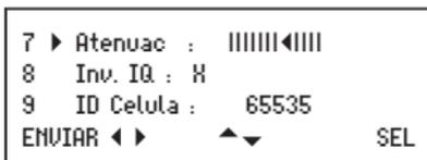
Atenuación : Es la atenuación del nivel de la señal COFDM de salida. Desplazando el cursor con las teclas ← y → se ajusta el nivel en tiempo real, es decir, no hay necesidad de ejecutar el comando ENVIAR. Para precisar el valor de ajuste en dB deberá hacerse uso de un analizador de espectro o un medidor de campo.
